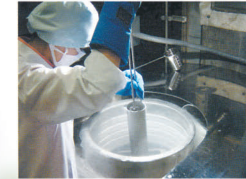
液体窒素タンクによる胚の冷凍保存
